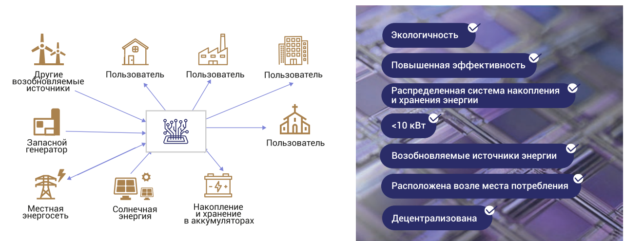
РИСУНОК 6. Схематическое представление микросети и ее основных характеристик
