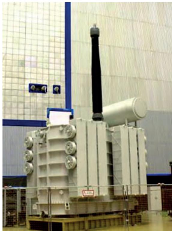
Рис. 4. Управляемый шунтирующий реактор
